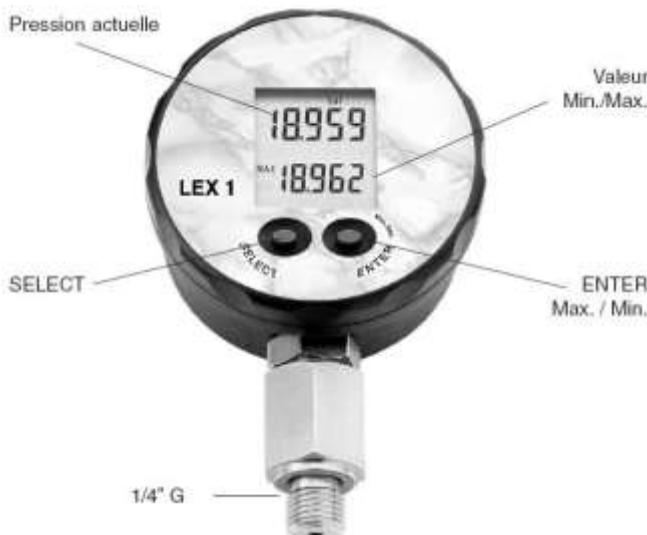
LEX 1 possède 2 touches. La touche de gauche (SELECT) permet de sélectionner les fonctions et l'unité de pression. La touche de droite (ENTER) valide la fonction ou l'unité de mesure sélectionnée. Cette même touche permet également de basculer entre les valeurs Min. et Max.
