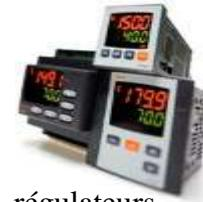
Les nouvelles gammes de régulateurs DR4000, 4800 et 7200 sont des gammes de régulateurs double affichage, avec connexion TTL (sauf les 4800). Cette connexion peut servir pour la copy carte (accessoire de programmation rapide), ou bien pour relier l'appareil à un système d'enregistrement Televis ou Modbus. Ces régulateurs fonctionnent en chaud ou en froid.
