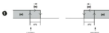
Alarme de température minimum Température inférieure ou égale à LA1/2 (LA1/2 avec signe)
