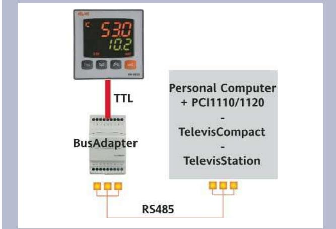
La connexion aux systèmes de télégestion Televis peut être effectuée à travers le port série TTL (pour cela, utiliser le module interface TTL- RS 485 BUS ADAPTER 130 ou 150) ou, dans les modèles pour lesquels elle est prévue (EW4822), par connexion directe RS485. Pour configurer ainsi l'instrument, il est nécessaire d'accéder au répertoire portant l'étiquette "Add" et d'utiliser les paramètres "dEA" et "FAA".
