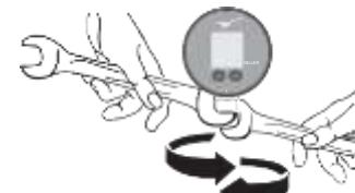
Visser LEX 1 sur l'installation et le serrer à l'aide de l'écrou 6 pans (couple serrage max. 50 Nm). Un contre-écrou maintient le capteur sur le boîtier.
