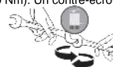
Orientation du plan de la face avant : Desserrer le contre écrou du boîtier à l'aide de deux clés plates. Le boîtier peut alors tourner par rapport au capteur. Orienter la face avant et resserrer le contre écrou. La face avant de LEO 1 est orientable sur 355°. Montages horizontal et inversé possibles.
