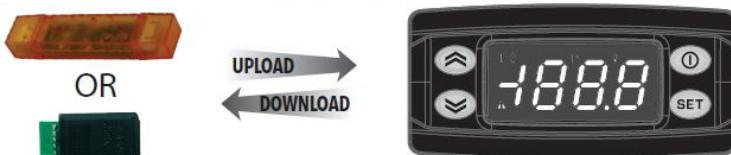
**REMARQUE:** après le téléchargement (download), l'instrument fonctionnera selon les paramétrages de la nouvelle liste qui vient d'être chargée.
