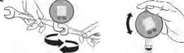
Visser RECORD sur l'installation et le serrer à l'aide de l'écrou 6 pans (couple serrage max. 50 Nm). Un contre-écrou maintient le capteur sur le boîtier.
